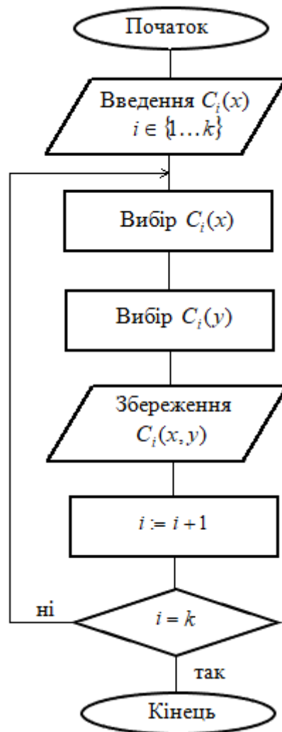
Рис 5.3. Алгоритм синтезу групи симетричних двохоперандних СЕТ-операцій які допускають перестановку операндів на основі однооперандних СЕТ-операцій базової групи
